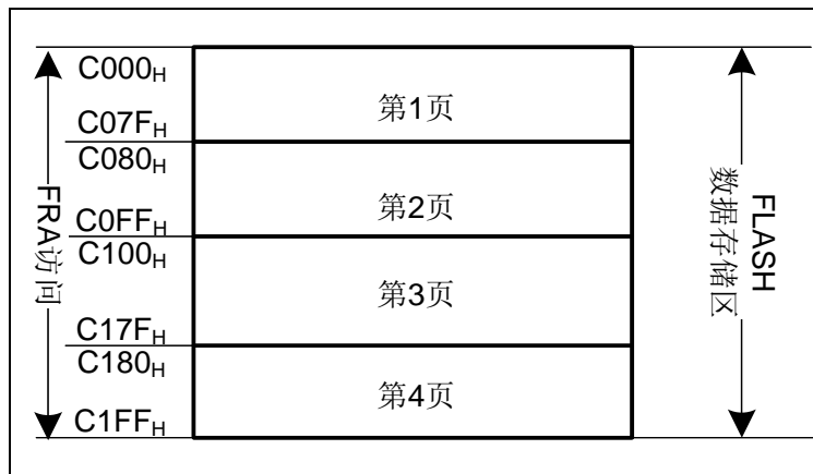
图 3-2 FLASH 数据存储区寻址空间映射图
